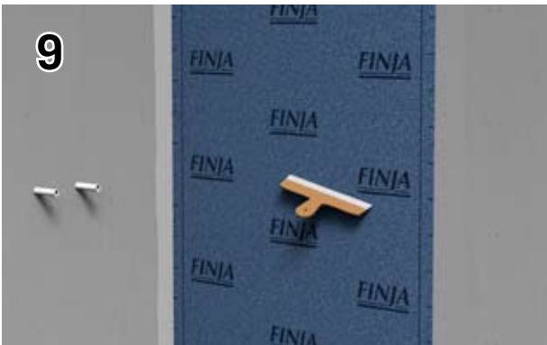
9 Därefter monteras tätduken omgående. Obs! Rolla inte större yta än att du hinner montera tätduk innan membranet torkar.
