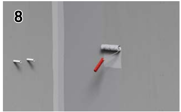
8 Efter det att alla förseglingar är gjorda rollas väggen flödigt med tätmembran. Åtgång 0,5 kg/m 2 . Tips! En våd åt gången.
